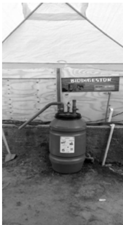
Figura 4 – Biodigestor produzido pela equipe do projeto no laboratório NUPEG
