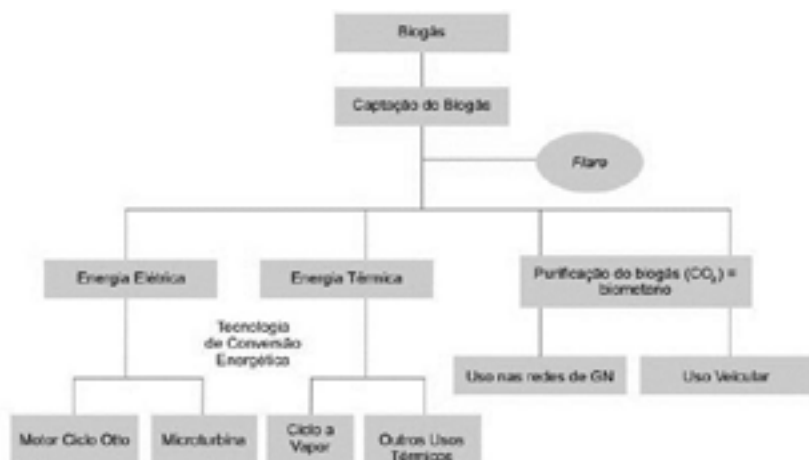
Figura 1 – Fluxograma de possíveis usos finais para o biogás
