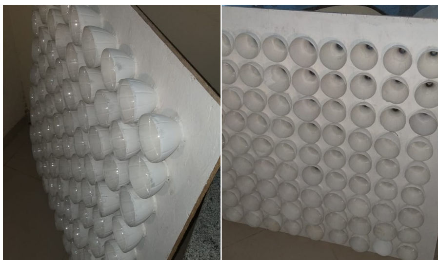
Imagem 2 - Protótipo do ar condicionado natural utilizando garrafas PET
